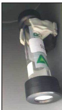
Abbildung 5.4: Passivsammler zur Bestimmung der Stickstoffdioxidkonzentration, Typ: Palmes
