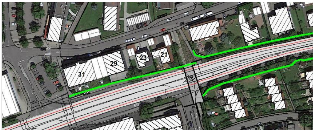
Abbildung 13: Lageplan Lärmschutzwand entlang der Grundstücksgrenzen
